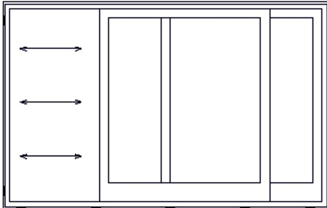
Öffnen Sie vor dem endgültigen Fixieren und Füllen der Fugen den Flügel um ca. 1 cm und kontrollieren Sie an mehreren Höhen das lichte Öffnungsmaß. Es muss überall gleich sein. Anderenfalls die Position des aufrechten Rahmens ggf. korrigieren.
